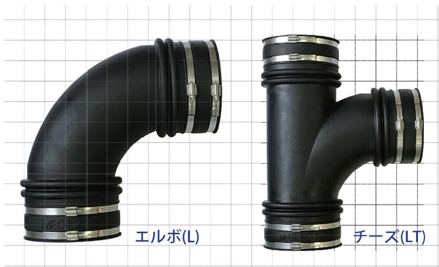
柔軟性に富み、L (エルボ) は角度  $90 \sim 98^\circ$ 、LT (チーズ) は  $90 \sim 96^\circ$  の範囲で自由設計できます。橋梁のたわみを吸収し、設計・施工ともに3次元の微調整が可能な継手です。
